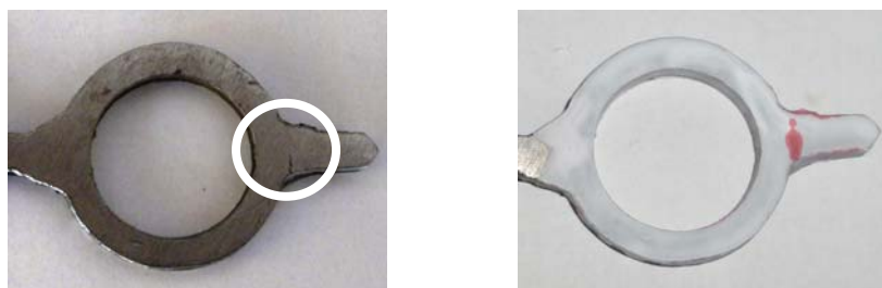
Slika 1. Nepotpuno zavaren spoj rebra i cijevi (Lijevo) i bojama istaknuta linija kontakta (Desno)
